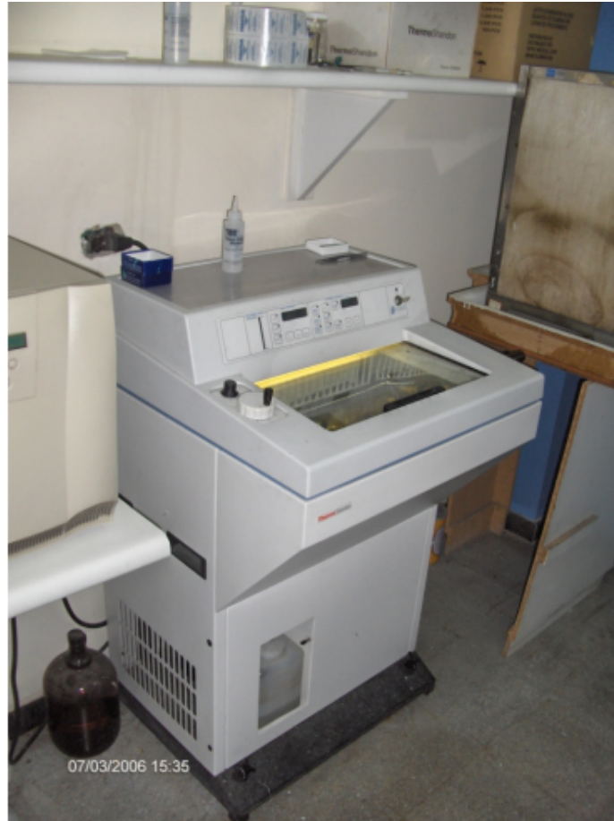
Figura 2: Criostato utilizado para el seccionamiento de tejidos durante el procesamiento histológico de muestras de Boophilus microplus . Este equipo permite realizar cortes de tejido de aproximadamente 3 a 4 \mu m de espesor a bajas temperaturas.
